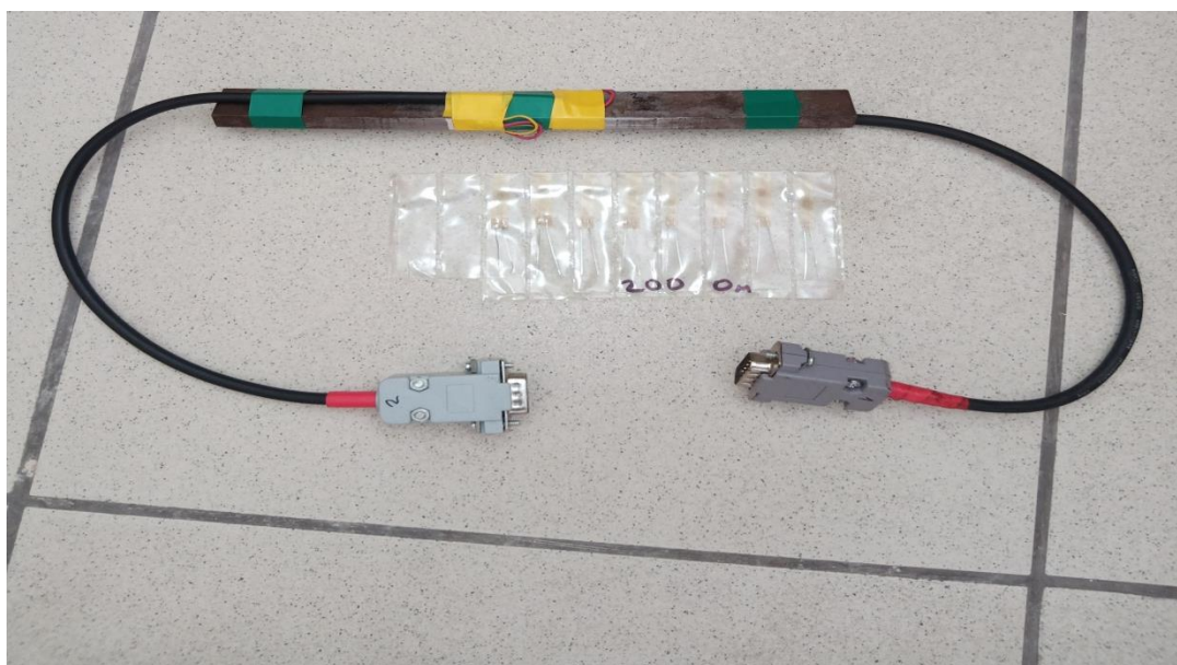
Рисунок 3 – Призматична балка для тарування тензорезисторів
