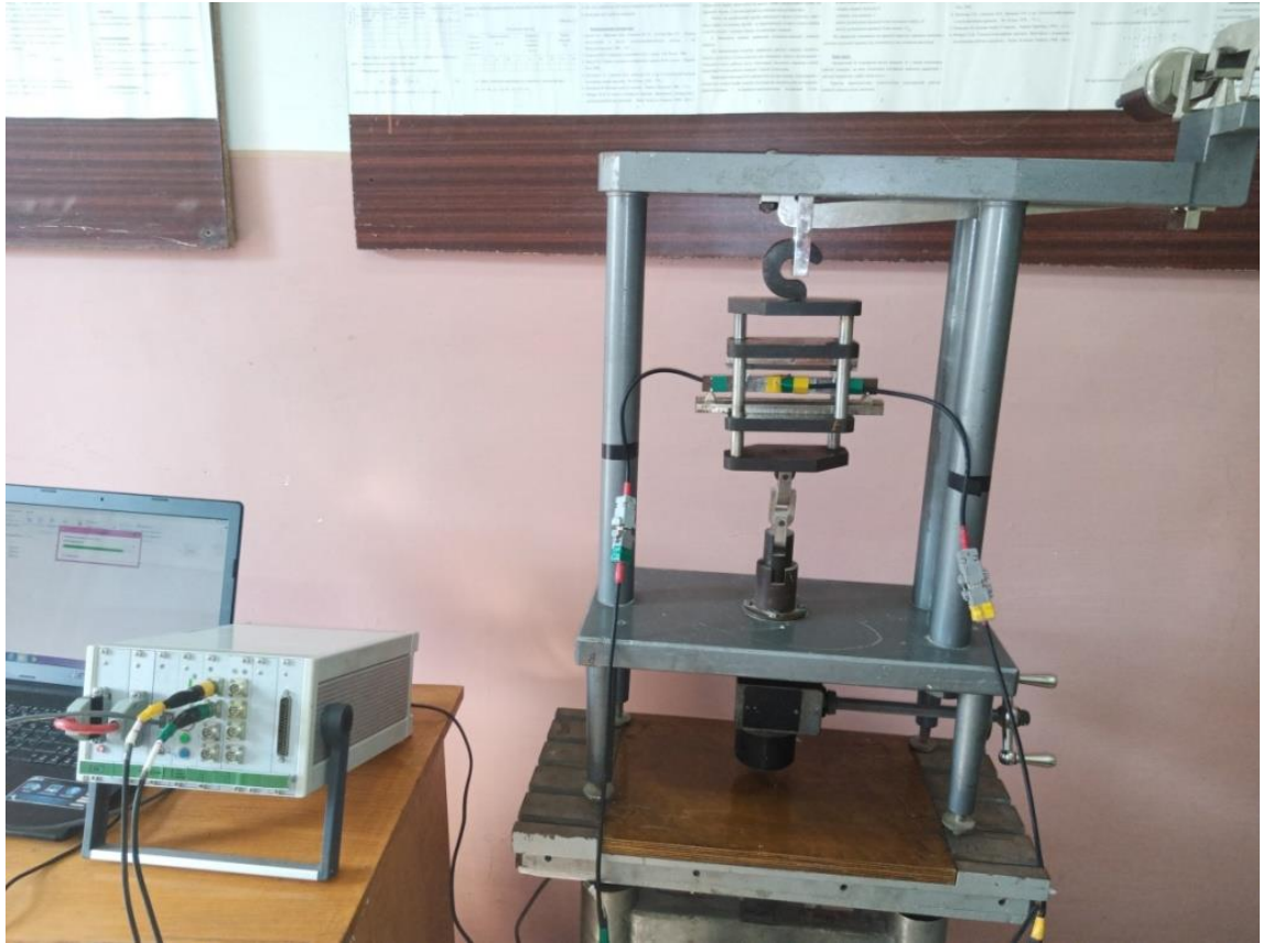
Рисунок 4 – Універсальний прес УП-8 для навантаження при таруванні тензорезисторів
