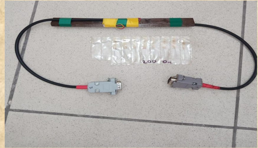
Тарування тензорезисторів з допомогою призматичної балки
