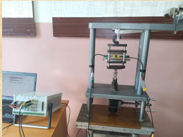
Процес тарування тензорезисторів на універсальному пресі УП-8
