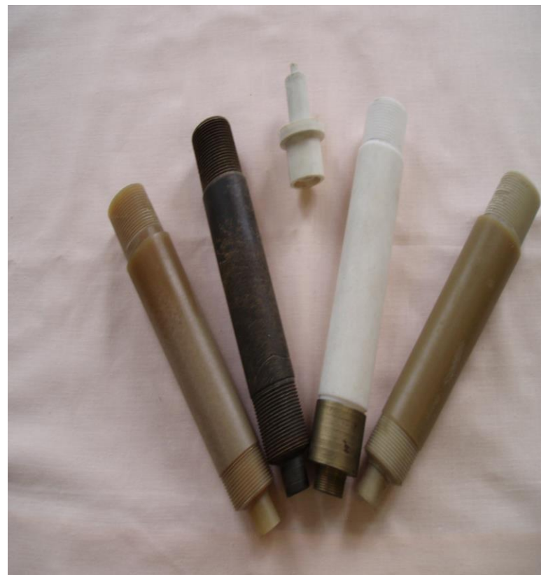
Розроблені діелектричні подовжувачі свічок запалювання газомоторних компресорів
