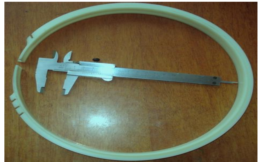
Конструкція направляючого кільця виготовленого по розробленій технології
