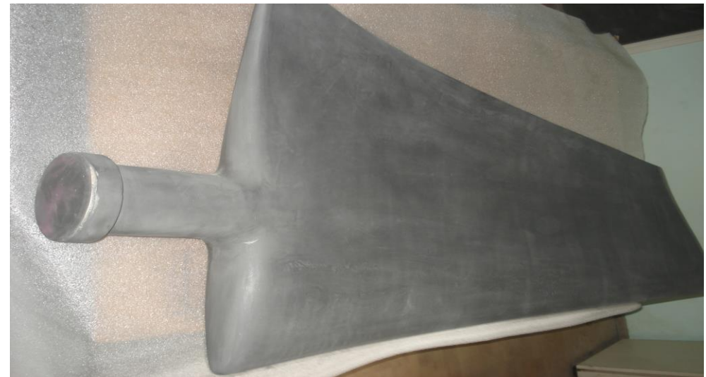
Відреставрована фірмова лопать вентилятора
