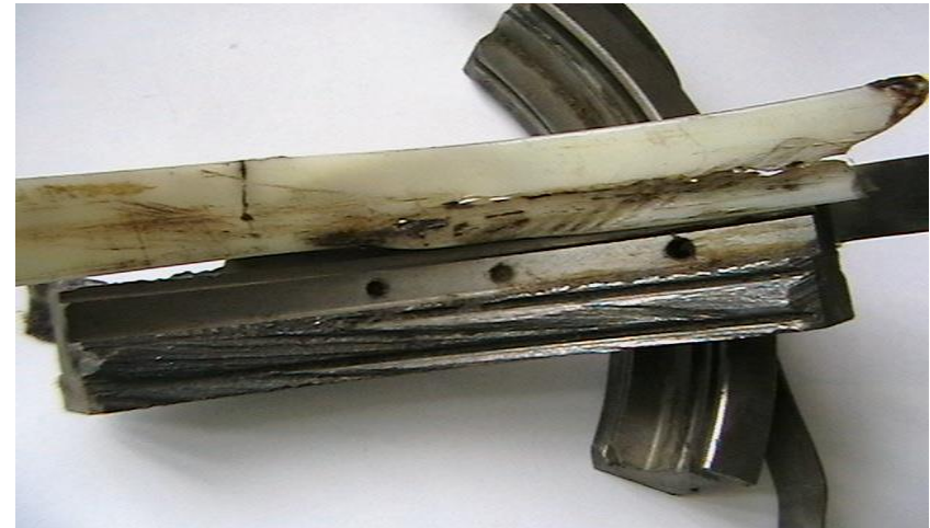
Пошкоджене фірмове направляюче кільце тросоукладача
